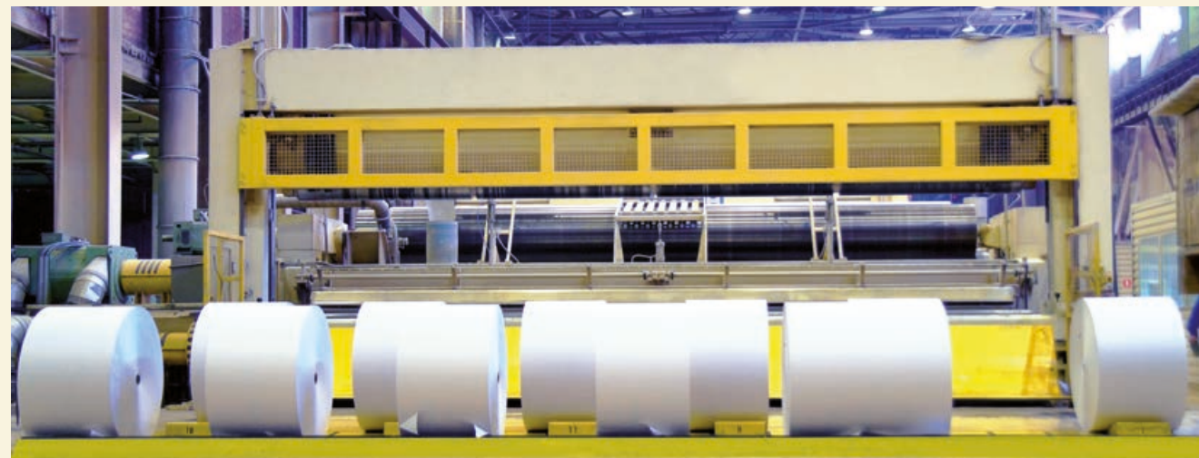
В АО «Волга» была освоена новая технология производства газетной бумаги из 100% термомеханической массы, что позволило существенно улучшить качественные характеристики газетной бумаги, использовать ее на высокоскоростном печатном оборудовании.
